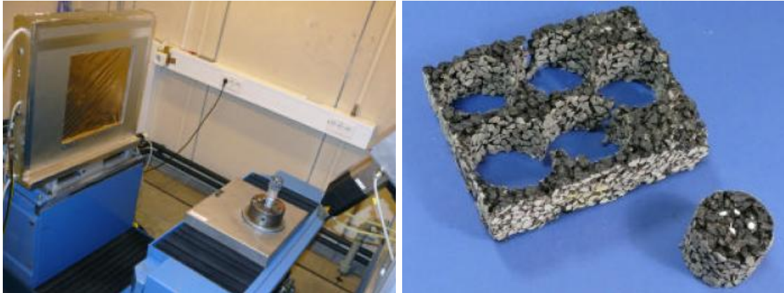
Slika 1: Na sliki levo je aparat z visoko ločljivim tomografom in desno vzorec jedra drenažnega asfalta
