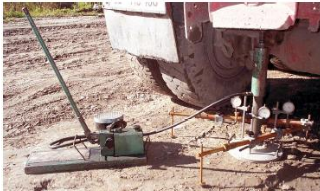
Slika 3: Shema krožne obremenilne plošče z opremo za meritve statičnega deformacijskega modula E_{vs}
