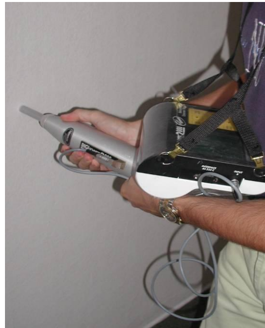
Nedestruktivne preiskave: Ugotavljanje površinske tlačne trdnosti betona
