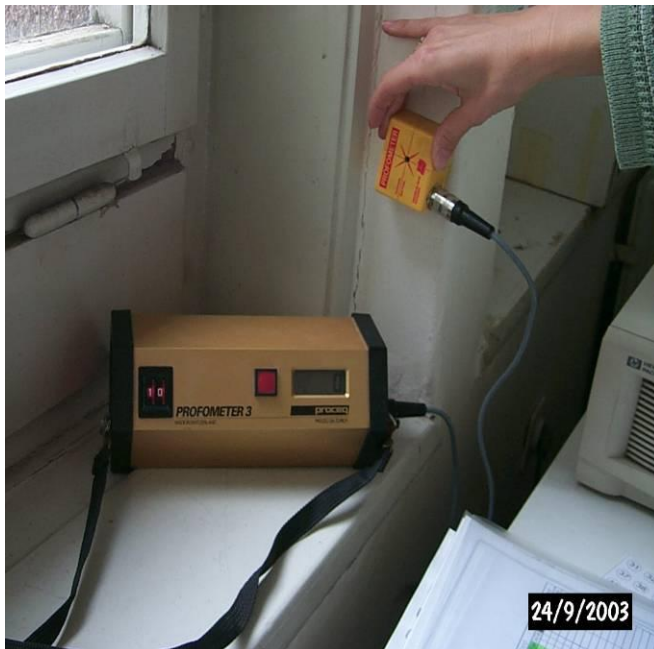
Nedestruktivne preiskave: iskanje armature v betonu s profometrom
